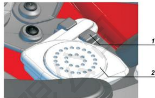
图7, 已安装通讯系统的附接板
